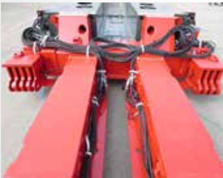
Traverse écartable, transformée en plateau à cheval
