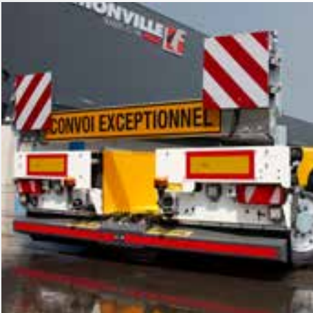
Feux arrière, pare-choc et panneaux élargisseurs
