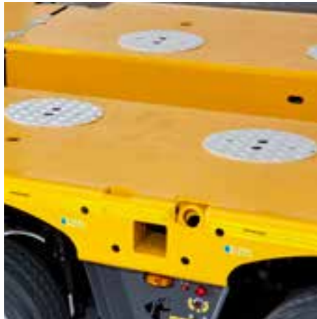
Point d'arrimage, pochette pour rancher, préparation pour élargisseur
