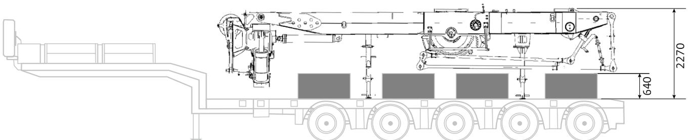
Configuration with 4 x 10 t counterweight slabs, 10 t MegaWingLift • Konfiguration mit 4x10 t Gegengewichtsplatten und 10 t MegaWingLift • Configuration avec 4 plaques de contrepoids de 10 t et MegaWingLift de 10 t • - Configuración con 4 placas de contrapeso de 10 t y MegaWingLift de 10 t • Configurazione con 4 bramme di contrappeso di 10 t, MegaWingLift di 10 t • Конфигурация с блоками-противовесами – 4 шт. x 10 т, MegaWingLift 10 т.
